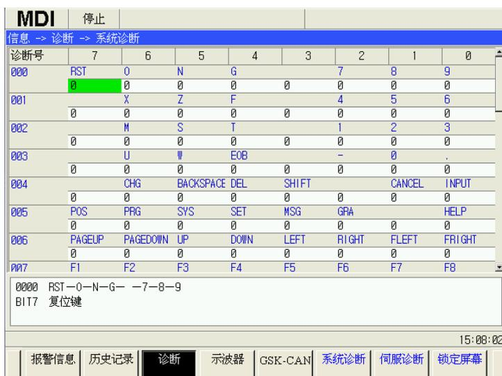
CNC系统诊断页面显示有键盘诊断、状态诊断及辅助机能参数等内容。可通过 、、、、、 键查看，为了防止在查看某些键（如：方向键和翻页键）的诊断信息时，产生对应的功能操作，可以通过 软件，锁定当前屏幕。
