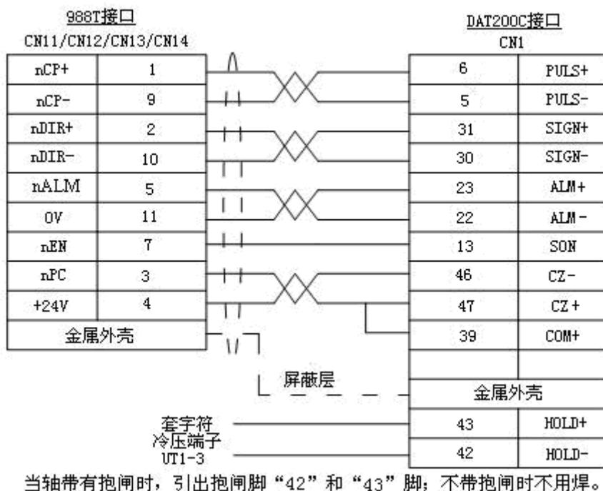
图 2-1-13 GSK988T 与 DAT2000C 系列驱动单元的连接
