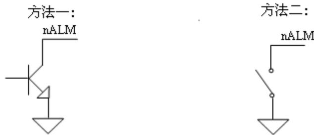
图 2-1-4 驱动单元提供信号的方式
